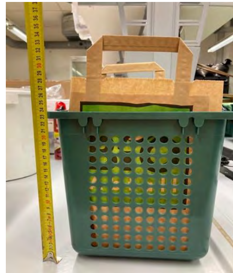
Abbildung 14: Adaptierungen für das Einbringen des Papiersackes in den gelochten Vorsammelbehälter
