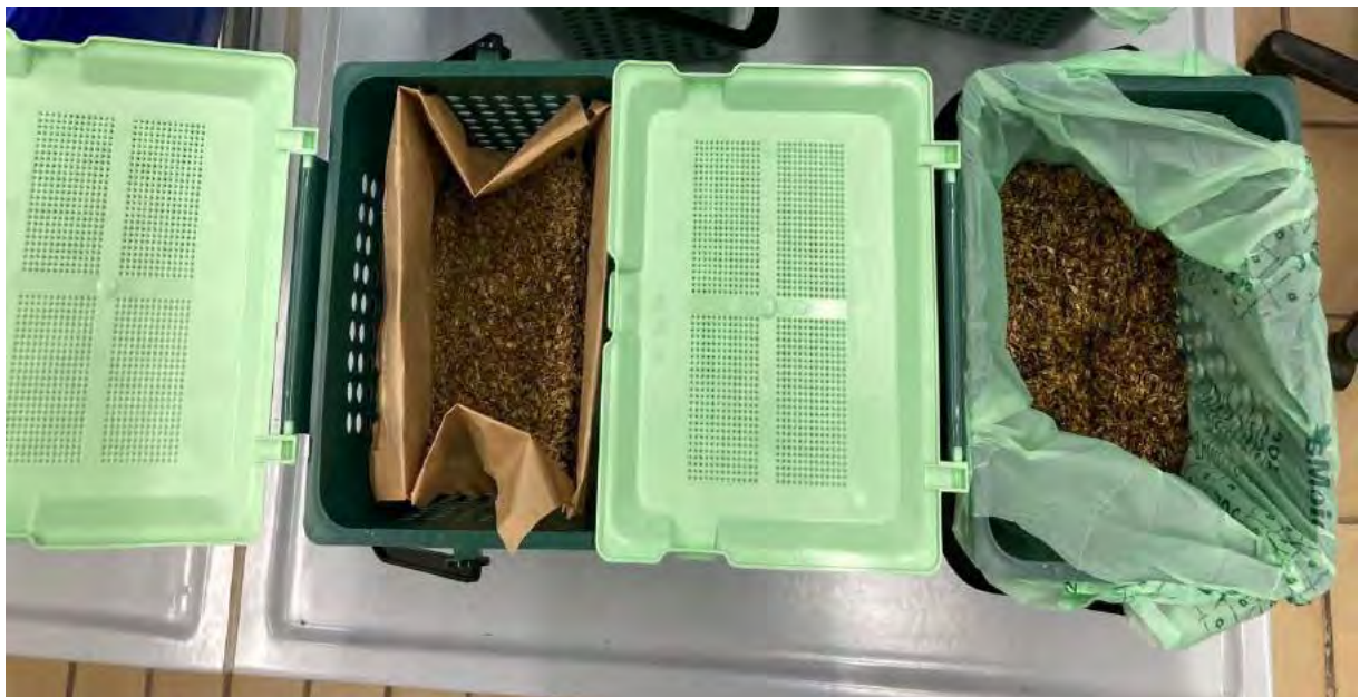
Abbildung XIII: Kein Kondenswasser auf den Deckeln der gelochten Behälter
