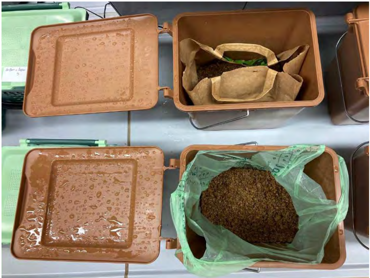
Abbildung XII: Die geschlossenen Vorsammelbehälter nach 72:00 Stunden. Erhebliche Kondenswasserbildung erkennbar
