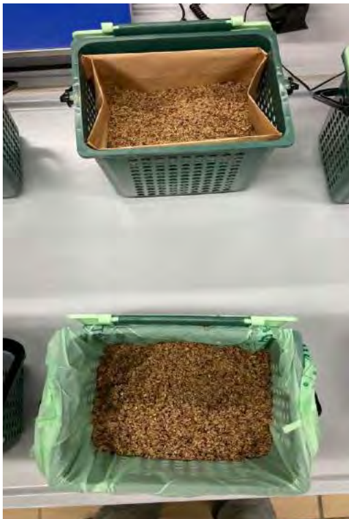
Abbildung 17: Die verwendeten Biotreber nach der Einwaage in die Vorsammelhilfen in den gelochten Vorsammelbehältern
