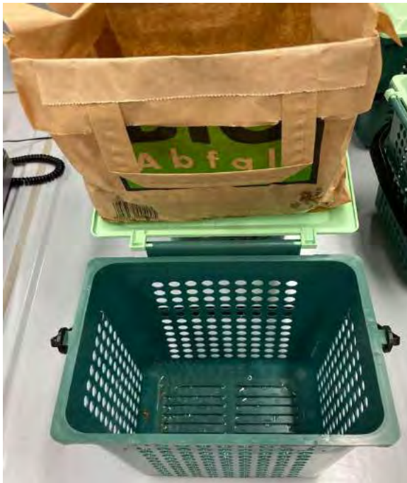
Abbildung XIV: Biomat AirBox mit Papiersack. Dieser ist auch nach 83:20 Stunden noch trocken
