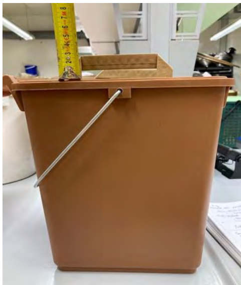
Abbildung 15: Überstand bei dem geschlossenen Vorsammelbehälter
