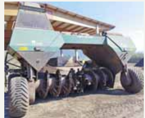
Mit diesen Umwendemaschinen werden die Mieten gewendet.
